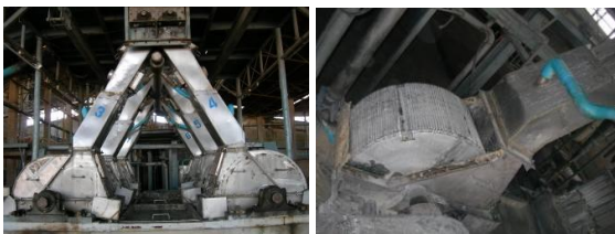
ภาพที่ 3 เครื่องสับโม และลักษณะภายในเครื่องโม
