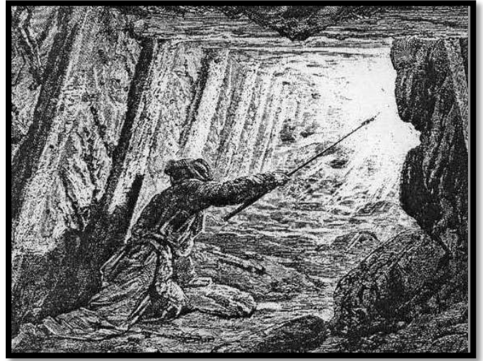
การจุดก๊าซมีเทนที่ถูกกัก (ตกค้าง) ในโพรงหรือหลุมแอ่งเล็กๆ เป็นหนึ่งในวิธีการที่ใช้ป้องกันการระเบิดในเหมืองถ่านหิน
