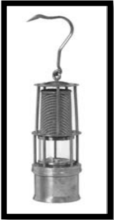
ภาพโคมไฟป้องกันการระเบิดในเหมืองถ่านหินหนึ่งในอุปกรณ์ป้องกันการระเบิดชิ้นแรกๆ ที่ผลิตโดย Cooper Crouse-Hinds CEAG ในประเทศเยอรมัน
