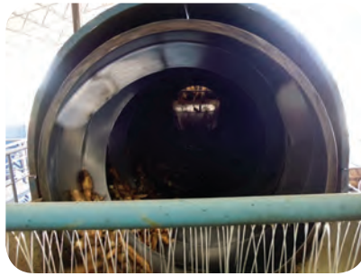
ภาพที่ 10 เครื่องร้อนหิน ดิน ถวาย สำหรับแยกสิ่งสกปรกออกจากหัวมันสำปะหลัง
