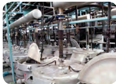
ภาพที่ 56 โรงงานผลิตแอมโมเนียที่ถูกไฟคลอก และสภาพเครื่องจักร อุปกรณ์ภายในโรงงานที่เสียหายจากไฟคลอก
