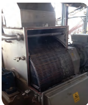
ภาพที่ 17 ข การจัดเรียงฟันใบบนลูกกลิ้งเครื่องโม
