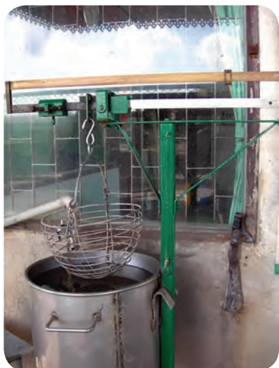
ภาพที่ 4 เครื่องวัดเปอร์เซ็นต์แป้ง ในหัวมันสด (Reiman scale) ในหน่วยรับวัตถุดิบ
