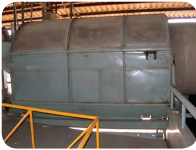
ภาพที่ 10 เครื่องร้อนหิน ดิน ถวาย สำหรับแยกสิ่งสกปรกออกจากหัวมันสำปะหลัง
