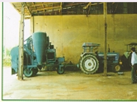
รถแทรกเตอร์พร้อมเครื่องดูด สูญญากาศสำหรับเก็บมันเส้น ที่แห้งแล้ว
