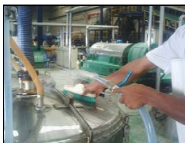
รูปที่ 6-5 การใช้หัวฉีดน้ำความดันร่วมกับการใช้แปรงล้าง
