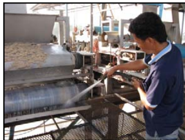
รูปที่ 6-2 การติดตั้งตัวกระจายกาก และใช้หัวฉีดน้ำแรงดันล้างทำความสะอาดสายพานอัดกาก
